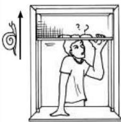
**FR** | La toile ne remonte plus: Le ressort nécessite d'être retenu. Pour cela dévissez l'embout du coffre côté ressort en le maintenant afin de ne pas vous blesser. Tournez l'embout avec son ressort de plusieurs tours et revissez le tout.
