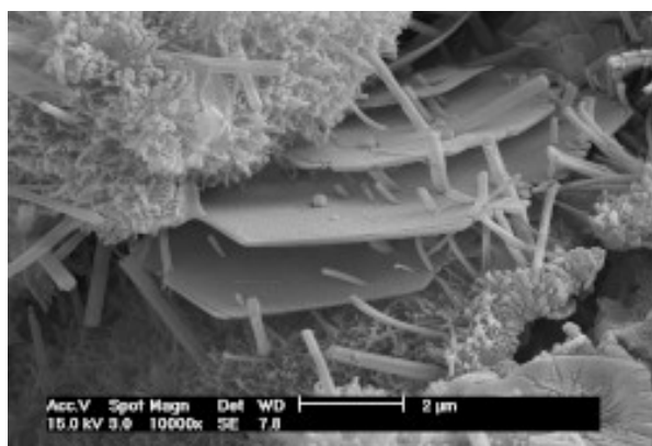
Hydratatie van een bindmiddel op basis van Portland cement in een traditionele voegmortel
