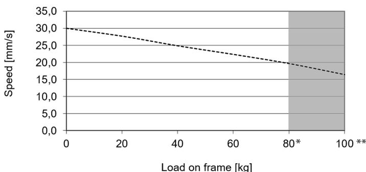
Ovenstående kurve gælder for en centralt placeret belastning og er kun gyldig i forbindelse med duty cycle: 10% ved 50% af den maksimale belastning eller maks. 2 min. uafbrudt. Ovennævnte specifikationer kan variere afhængigt af lokale temperaturer, luftfugtighed og netspænding.
