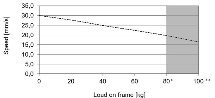
Die oben angezeigte Kurve bezieht sich auf eine mittig platzierte Last und ist nur gültig in Bezug auf die Einschaltdauer: 10% bei 50% der maximalen Nutzlast oder maximal 2 Minuten ohne Unterbrechung. Die oben angegebenen Daten können je nach Raumtemperatur, Luftfeuchtigkeit und Anschlußspannung variieren.
