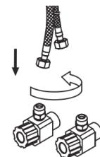
6. Wickeln Sie Klempnerband um das Gewinde des Wasserhahns. Verbinden Sie die flexiblen Anschlüsse (8&9) mit den Eckventilen und ziehen Sie sie fest.
