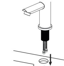
3. Placez le robinet avec le tube d'installation dans le trou du robinet.
