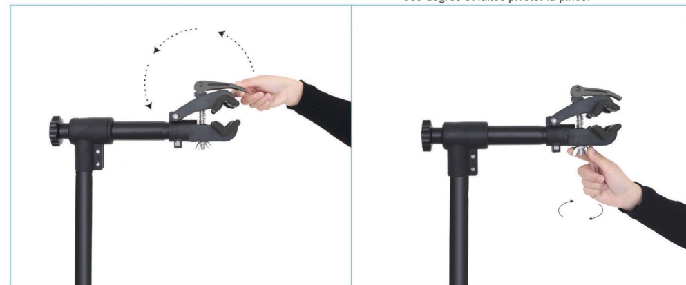
8 Relâchez la clé à dégagement rapide pour ouvrir la pince, serrez l'écrou à oreilles pour ajuster légèrement le diamètre intérieur de la pince pour l'adapter aux différents cadres de vélo.
