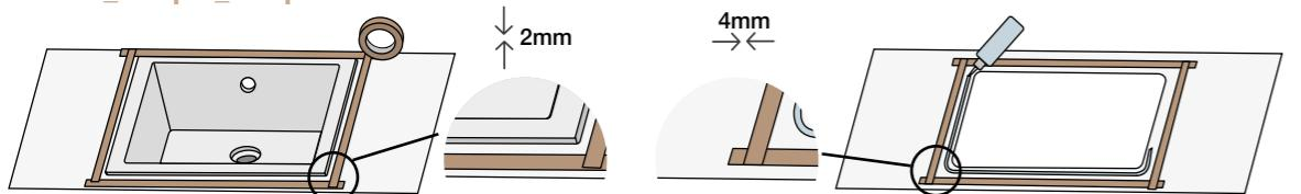
Encastrar el fregadero dentro de la encimera, comprobando que no se muestren los huecos de luz. A continuación proteger la encimera con cinta de carrocería a 2 mm del fregadero. Retirar el fregadero. Colocar un cordón de silicona a 4 mm de cinta.
