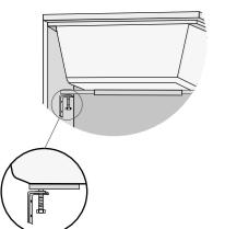
Presentar el fregadero en su posición definitiva y colocar el soporte de anclaje sobre las escuadras fijadas. Mediante los tornillos de regulación ajustar la barra hasta que el fregadero quede sujetado. Comprobar por la parte superior que la posición es la deseada y si es necesario ajustar de nuevo el anclaje.
