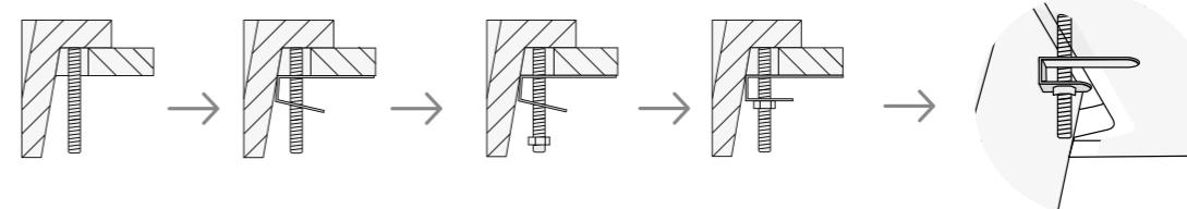
Inmediatamente volver a colocar el fregadero en la posición delimitada. A continuación colocar las garras de anclaje sobre los espárragos que se hayan colocado y apretar la tuerca hasta un agarre firme.
