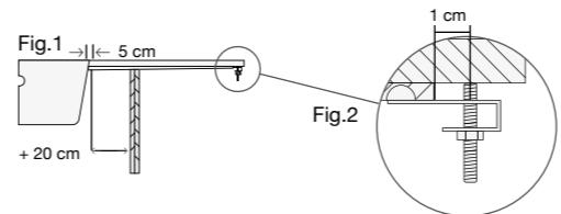
1 - Para la colocación del escurridor junto a una cubeta, respetar las medidas indicadas en la figura 1.
