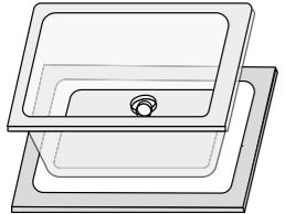
Comprobar que el fregadero encastre sin que tropiece en las zonas de anclaje y sin que existan huecos de luz visibles. Para ello, usar el fregadero sobre el hueco o con la plantilla que se suministra, únicamente en aquellos modelos que la incluyan. Toda plantilla que no esté incluida en la caja se puede descargar a través de nuestra web [www.poalgi.es](http://www.poalgi.es)
