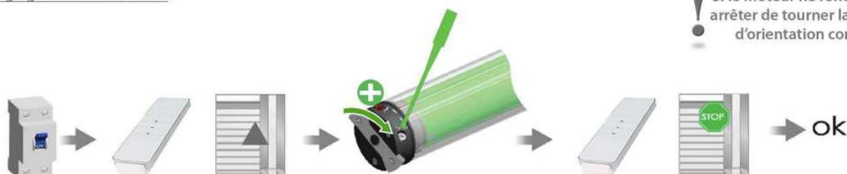
! Si le moteur ne fonctionne pas, arrêter de tourner la vis du sens d'orientation concernée.
