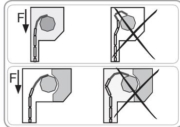
Remarque : Utiliser au moins 2 verrous ou 2 liens rigides pour fixer le volet roulant au tube d'enroulement.
