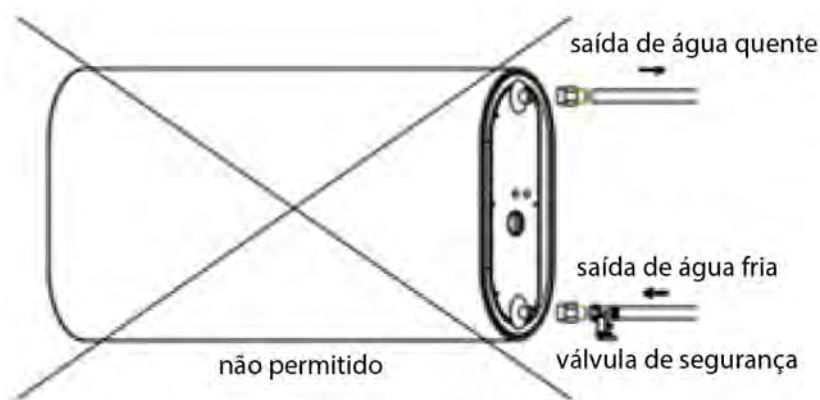
Figura 3: Instalação não conforme
