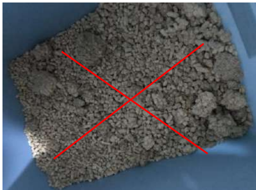
Slepování pelet špatné kvality
