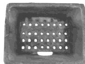
Beispiel eines sauberen Tiegels
