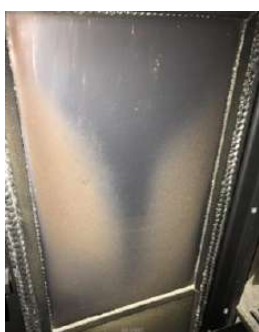
Beispiel einer verschmutzten Scheibe
