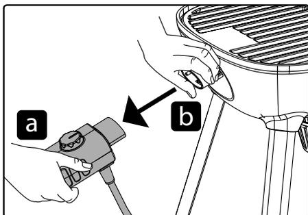
Débranchez le cordon d'alimentation du régulateur de température. Saisissez le régulateur de température par sa base, située à l'arrière du bouton de régulation (a) puis tirez pour le retirer de la fiche (b).
