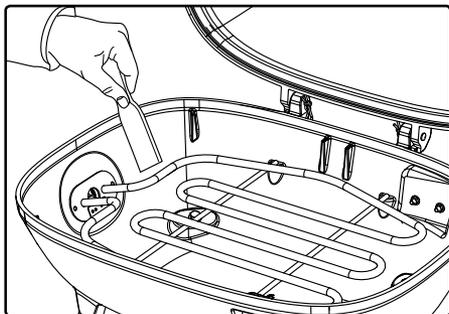
Grattez l'intérieur de la cuve de cuisson à l'aide d'un racloir en plastique afin d'éliminer les excès de graisse.
