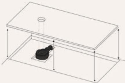
Verificar que a válvula coincida com o orifício da base e que exista folga entre ambos.
