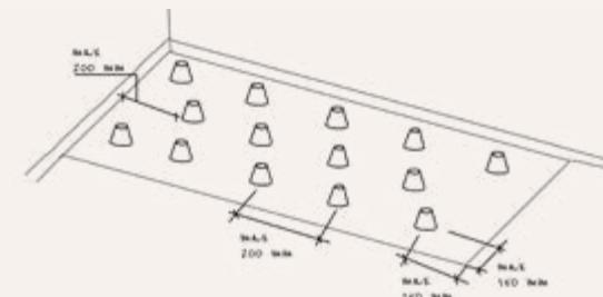
Befestigen Sie die Füße gemäß den Anweisungen des Herstellers am Boden. Für die richtige Menge und Positionierung, schauen Sie die Skizze. Nehmen Sie mit Hilfe der Wasserwaage eine erste Justierung der Füße vor, um eine flache Auflage zu erhalten. Diese Phase ist unerlässlich, um eine effektive Entwässerung zu erreichen. Ordnen Sie die Duschwanne an und überprüfen Sie, ob die Wanne um ihren gesamten
