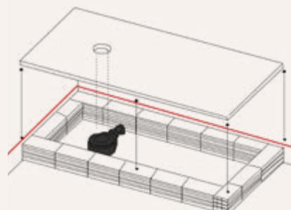
Comprobar que la válvula coincide con el orificio del plato y que exista holgura entre ambos.
