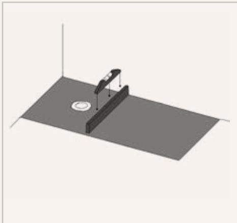
Repartir uniformemente a la vez que se comprueba el nivelado que se va dejando. Dejar fraguar el mortero según especificaciones del fabricante. Una vez esté completamente seco el producto comprobar que el nivel sea correcto.
