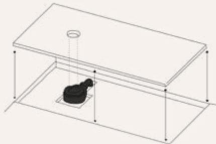
Prüfen Sie, ob der Duschteller korrekt positioniert ist und der Sifon mit dem Loch im Duschteller übereinstimmt. Das Loch im Duschteller muss dem Sifon entspricht.
