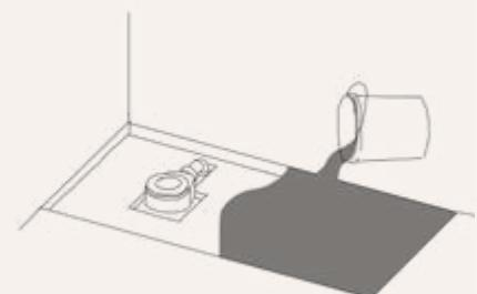
Vérifier que la zone d'installation soit correctement nivelée et propre. Si besoin, placer du mortier sur celle-ci pour la niveler.
