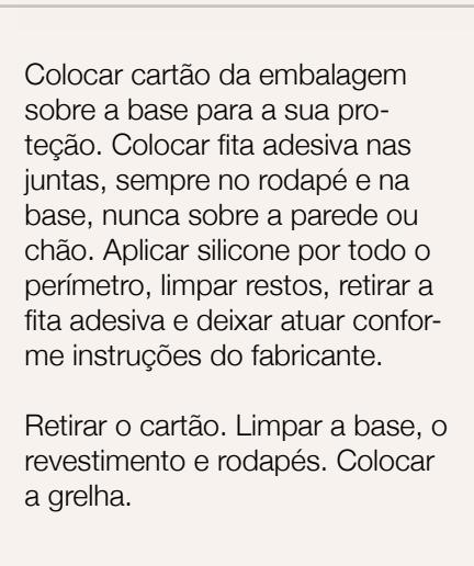
Colocar cartão da embalagem sobre a base para a sua proteção. Colocar fita adesiva nas juntas, sempre no rodapé e na base, nunca sobre a parede ou chão. Aplicar silicone por todo o perímetro, limpar restos, retirar a fita adesiva e deixar atuar conforme instruções do fabricante.
