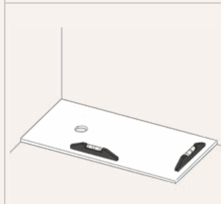
Colocar el plato y dejar que el producto actúe según especificaciones del fabricante. Terminar el montaje de la válvula. Comprobar el nivelado. Comprobar con agua que el plato desagüe correctamente. Colocar el revestimiento de la pared con panel o azulejos.
