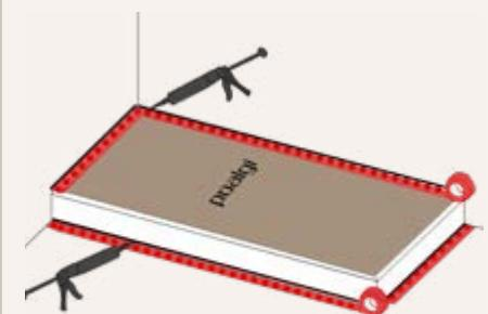
Placer le carton d'emballage sur le receveur pour le protéger. Placer de l'adhésif de masquage sur le receveur (jamais sur le sol ou sur le mur). Appliquer de la silicone sur tout le périmètre et nettoyer. Retirer l'adhésif et laisser sécher selon les instructions du fabricant.
