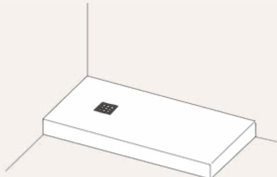
Prüfen Sie vor der Installation, dass die Oberfläche des Duschstellers nicht beschädigt ist und, dass sie auf einer ebenen Fläche vollständig aufliegt und waagerecht positioniert ist.
