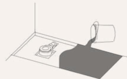
Prüfen Sie, ob die Auflage (Boden) für den Duschteller eben und frei von Ablagerungen ist. Wenn der Duschteller-Bereich uneben ist, muss dieser ausnivelliert werden. Verwenden Sie hierzu eine Nivelliermasse welche für Nassbereiche geeignet ist.
