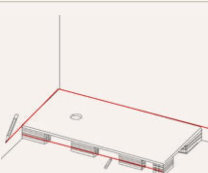
Poser le receveur sur le bâti-support jusqu'à atteindre la hauteur souhaitée. Marquer la hauteur de l'installation. Laisser sans carreler la première rangée de faïence pour un bon ajustement et étanchéité.
