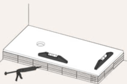
Colocar os rodapés e deixar atuar, conforme indicações do fabricante. Verificar que esteja nivelada. Terminar de montar a válvula e verificar que a base drene corretamente. Colocar o revestimento da parede com azulejos ou painéis.
