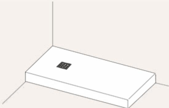
Antes de la instalación comprobar que no hay desperfectos en la superficie del plato y esté apoyado en superficie plana y posicionado en horizontal.
