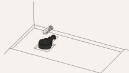
Montar a válvula conforme instruções do fabricante e conectar com o tubo PVC do dreno. Verificar que não existam fugas.
