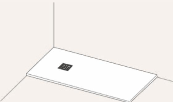
Antes da instalação verificar que não hajam defeitos na superfície da base e que esteja apoiada numa superfície plana e em posição horizontal.
