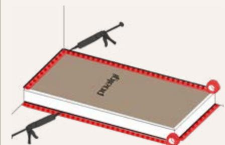
Colocar el cartón de embalaje sobre el plato para su protección. Colocar cinta de carrocería en las juntas, siempre sobre el plato y los zócalos, nunca sobre pared y suelo. Aplicar silicona por todo el perímetro, limpiar los restos, retirar la cinta y dejar actuar según especificaciones del fabricante.
