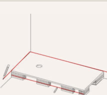
Calzar el plato con ladrillos hasta alcanzar la altura deseada. Señalar la línea por donde quedará el plato y la posición de los ladrillos. Dejar sin alicatar la primera fila de azulejos para un ajuste y sellado correctos.
