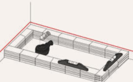
Prüfen Sie, ob der Duschteller korrekt positioniert ist und das Duschventils mit dem Loch im Duschteller übereinstimmt. Das Loch im Duschteller muss dem Duschventils entspricht.
