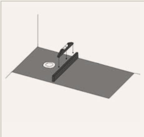
Répartir le mortier uniformément en s'assurant du bon nivellement de l'ensemble de la surface. Laisser sécher le temps nécessaire selon les instructions du fabricant et vérifier que l'ensemble de la surface soit de niveau.
