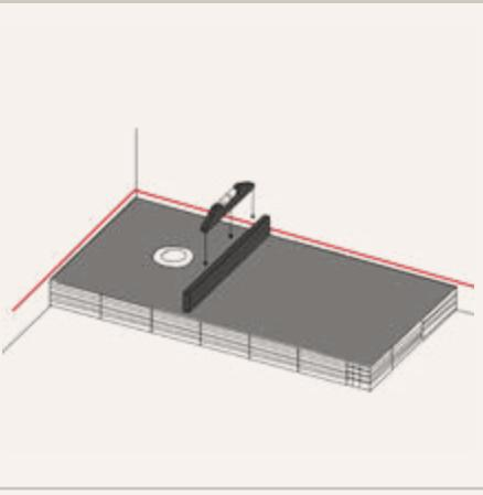
Verteilen Sie die Nivelliermasse gleichmässig und prüfen Sie dabei die Ebenheit. Lassen Sie den Mörtel bzw. Wenn das Produkt vollständig getrocknet ist, prüfen Sie, ob der Duschteller-Bereich eben ist. Dieser sollte keine Unebenheiten mehr aufweisen.
