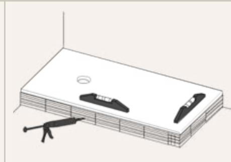
Prüfen Sie dass der Duschteller gerade (ausnivelliert) liegt. Tragen Sie Dichtungsmasse vom Typ Sikaflex® oder ähnliches auf.
