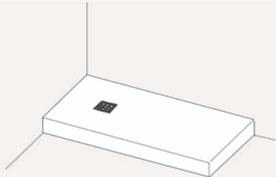
Prüfen Sie vor der Installation, dass die Oberfläche des Duschtellers nicht beschädigt ist und dass sie auf einer ebenen Fläche vollständig aufliegt und waagerecht positioniert ist.
