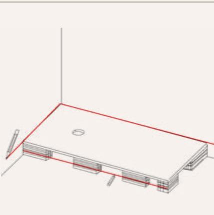
Fluchten Sie 15 mm für die Wandverkleidung des Sockels und benutzen Sie einen Fugendichtstoff, wie zum Beispiel Sikaflex oder ähnlich. Für andere Wandverkleidungen schlagen Sie nach Dicken und entscheiden Sie die geeigneter Versiegelung.
