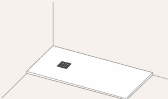
Avant installation, vérifier que la surface du receveur ne soit pas endommagée et que la zone d'installation soit parfaitement plane et horizontale.
