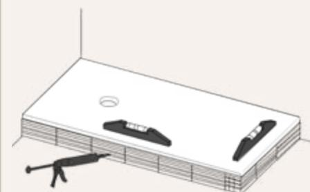
Una vez colocado el plato, comprobar el nivelado del mismo. Aplicar sellador tipo Sikaflex o similar, en la zona del zócalo.
