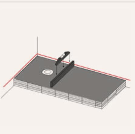
Repartir uniformemente a la vez que se comprueba el nivelado que se va dejando. Dejar fraguar el mortero según especificaciones del fabricante. Una vez esté completamente seco el producto comprobar que el nivel sea correcto.
