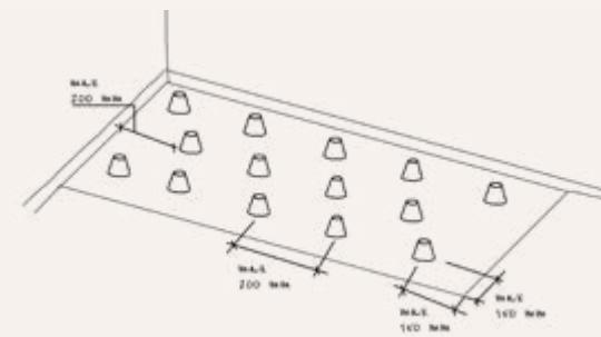
Fixar os pés no chão segundo as instruções do fabricante. Para saber a quantidade e a posição adequada, observe o desenho. Com a ajuda de um nível de bolha, proceda à primeira verificação com o fim de obter um suporte plano.
