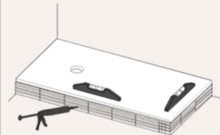
Une fois le receveur placé, vérifier qu'il soit de niveau. Appliquer de la colle mastic au niveau de la zone d'emplacement des plinthes.
