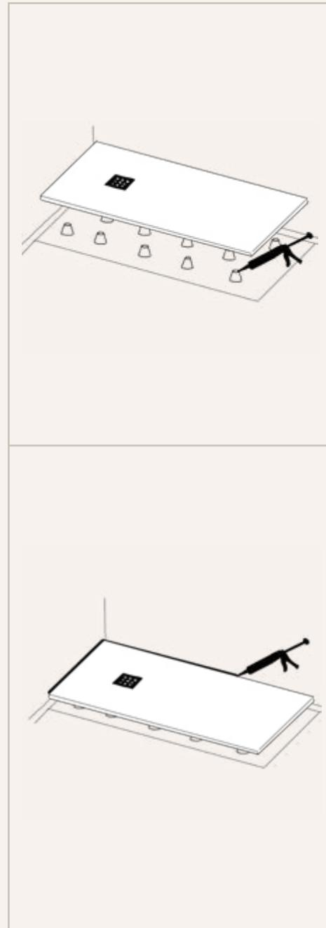
Entfernen Sie nach diesen Kontrollen die Duschwanne und tragen Sie Klebepunkte auf die Fußspitzen auf (Polyurethan- oder Silikonkleber).
