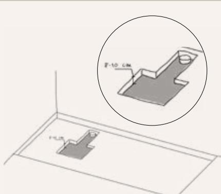
Réaliser une saignée dans le sol (profondeur comprise entre 80 et 100 mm) allant de l'évacuation jusqu'au futur emplacement de la bonde. Laisser sans carreler la première rangée de faïence pour un bon ajustement et étanchéité.
