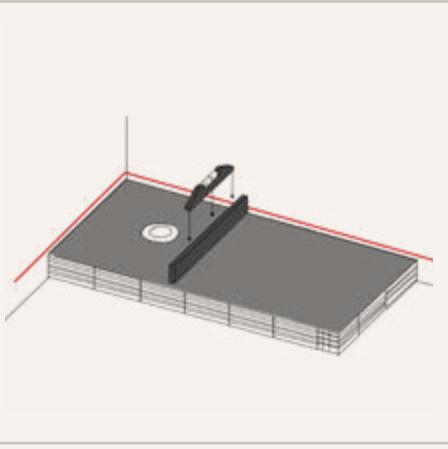
Répartir le mortier uniformément en s'assurant du bon nivelingement de l'ensemble de la surface. Laisser sécher le temps nécessaire selon les instructions du fabricant et vérifier que l'ensemble de la surface soit de niveau.
