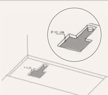
Abrir roza en el suelo desde el desagüe hasta la ubicación de la válvula. El hueco debe tener una profundidad entre 80 - 100 mm. Dejar sin alicatar la primera fila de azulejo para el ajuste y sellado correctos.
