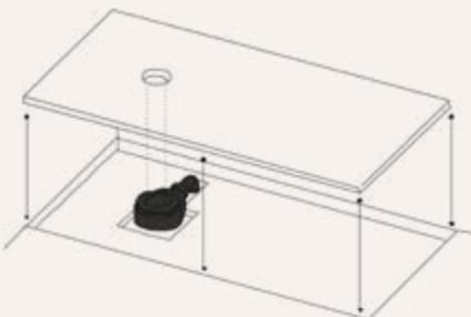
Comprobar que la válvula coincide con el orificio del plato y que exista holgura entre ambos.
