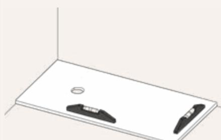
Colocar a base e deixar o produto faça efeito segundo instruções do fabricante. Terminar de montar a válvula. Verificar o nível. Verificar com água que a base drene corretamente. Colocar o revestimento da parede com azulejos ou painéis.
