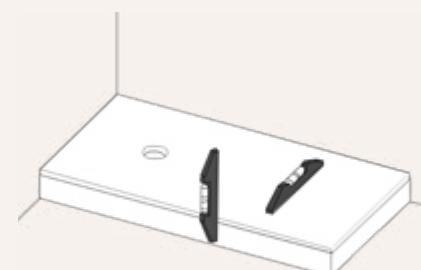
Legen Sie die Sockel auf und lassen Sie das Produkt nach den Angaben des Herstellers trocknen. Führen Sie die Sifonmontage durch. Prüfen Sie dass der Duschteller gerade (ausnivelliert) liegt. Prüfen Sie mit Wasser, ob dieses richtig abläuft. Verlegen Si nun den Wandbelag mit Paneelen oder Fliesen.
