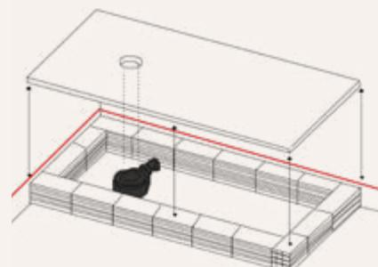
Vérifier que la zone d'installation soit correctement nivelée et propre. Si besoin, placer du mortier à l'intérieur de la zone construite.
