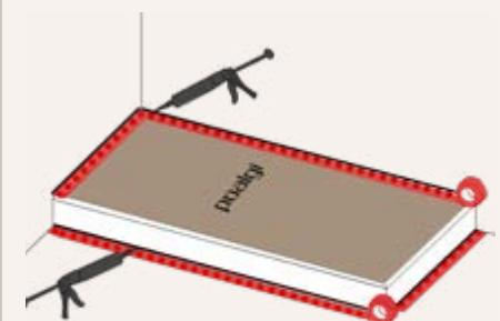
Legen sie den Karton der Verpackung zum Schutz auf des Duschtellers. Kleben Sie ein Klebeband an die Dichtungen und auf den Duschteller, niemals an die Wand und oder an den Boden. Tragen Sie Silikon rundum den Duschteller auf (Silikonfuge erstellen) und reinigen Sie die Reste. Entfernen Sie das Klebeband und lassen Sie das Silikon gemäss den Angaben des Herstellers aushärten. Entfernen Soe den Karton, reinigen Sie den Duschteller und die Wandverkleidung. Platzieren Sie das Ablaufgitter.
