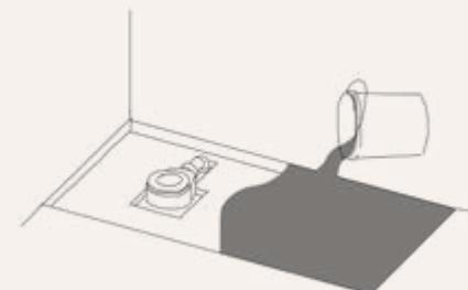
Comprobar que la base esté nivelada y limpia de restos. Colocar el mortero en caso de tener que nivelar la zona.
