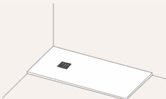
Antes de la instalación comprobar que no hay desperfectos en la superficie del plato y esté apoyado en una superficie plana y posicionado en horizontal.
