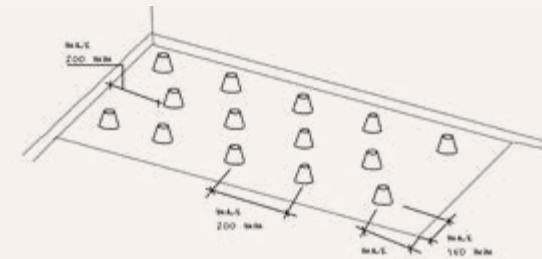
Fijar los pies en el suelo según las instrucciones del fabricante. Para conocer la cantidad y el posicionamiento adecuado, observe el croquis.
