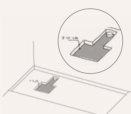
Offene Fuge im Boden schneiden vom Abfluss bis zur Sifonposition. Die Aussparung sollte eine Tiefe von 80 - 100 mm haben. Für eine ordnungsgemäss Verlegung und Abdichtung sind für die erste Fliesenreihe keine Fliesen erforderlich.
