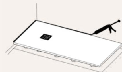
Réaliser l'étanchéité finale avec un mastic silicone tout autour du receveur dont les parties sont en contact avec le mur, la faïence ou le sol.
