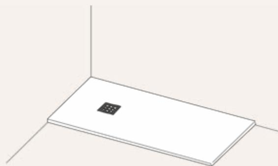
Prüfen Sie vor der Installation, dass die Oberfläche des Duschtellers nicht beschädigt ist und dass sie auf einer ebenen Fläche vollständig aufliegt und waagerecht positioniert ist.
