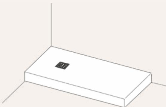
Avant installation, vérifier que la surface du receveur ne soit pas endommagée et que la zone d'installation soit parfaitement plane et horizontale.
