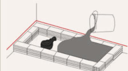
Comprobar que la base esté nivelada y limpia de restos. Colocar el mortero dentro del hueco construido.
