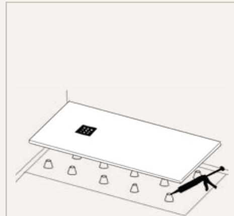
Une fois les vérifications effectuées, relever le receveur de douche et appliquer des points de colle sur le sommet des pieds (colle polyuréthane ou silicone). Repositionner ensuite définitivement le receveur sur les pieds et fixer définitivement la bonde d'évacuation au receveur de douche suivant les indications du fabricant.
