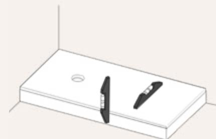
Placer les plinthes et laisser sécher la colle mastic selon les instructions du fabricant. Installer la faïence murale. Terminer le montage de la bonde. Contrôler le niveau. Mettre en eau pour vérifier que l'évacuation s'effectue correctement.
