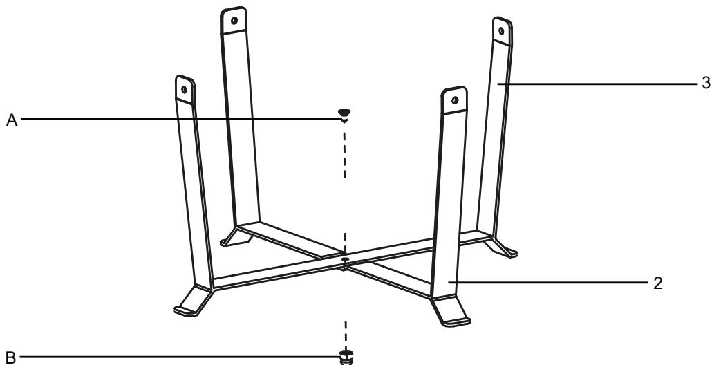
**FASE 2:** Fissare la staffa assemblata nella FASE 1 all'anello di rinforzo (1) utilizzando quattro viti (A) e quattro dadi arrotondati (B).
