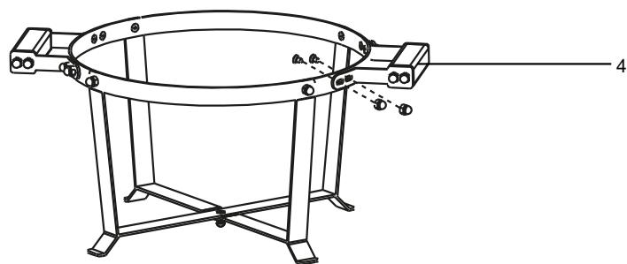
**FASE 3:** Fissare le due maniglie (4) al coperchio dell'anello di rinforzo (1). Allineare i fori delle maniglie con i bulloni preinstallati sul coperchio e fissare ogni maniglia (4) con i quattro dadi arrotondati preassemblati (B).
