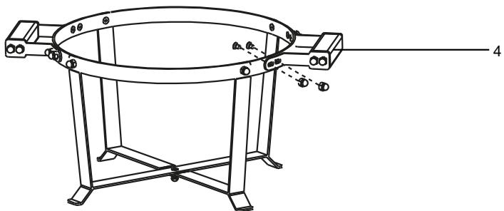
**ÉTAPE 3 :** Fixez les deux poignées (4) au couvercle de l'anneau de renforcement (1). Alignez les trous des poignées avec les boulons préinstallés sur le couvercle et fixez-les à l'aide des quatre écrous bombés préinstallés (B).
