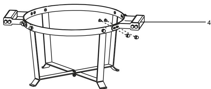
**STAP 3:** Bevestig de twee handgrepen (4) aan het deksel van de verstevigingsring (1). Lijn de schroefgaten van de handgreep uit met de voorgeïnstalleerde bouten op het deksel. Bevestig de handgreep (4) met de vier voorgemonteerde halfronde moeren (B).
