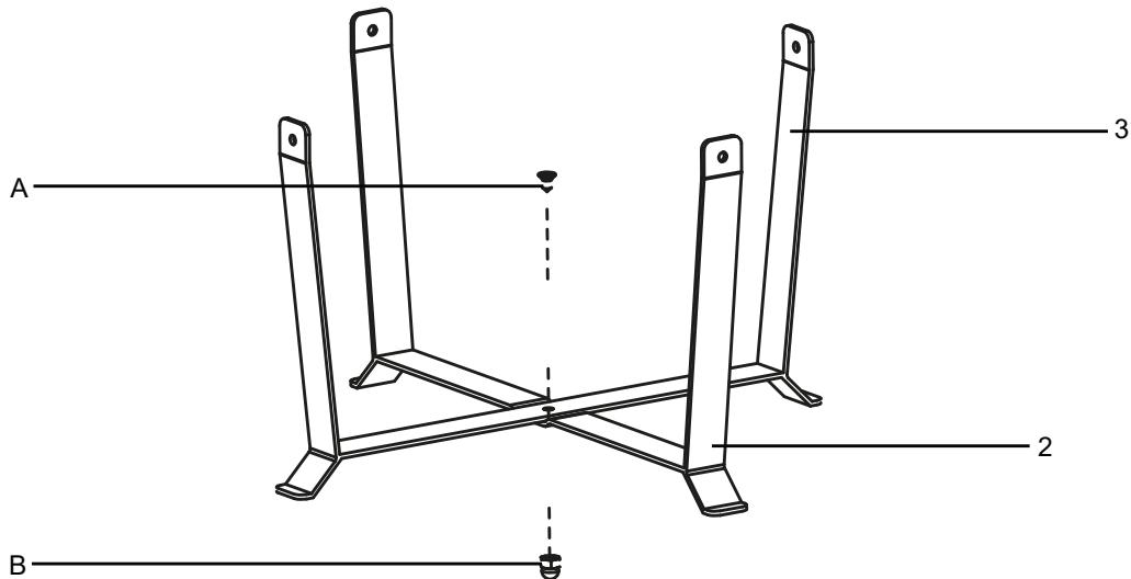
**SCHRITT 2:** Befestigen Sie die Halterung aus SCHRITT 1 an dem Verstärkungsring (1) mit vier Schrauben (A) und vier halbrunden Muttern (B).
