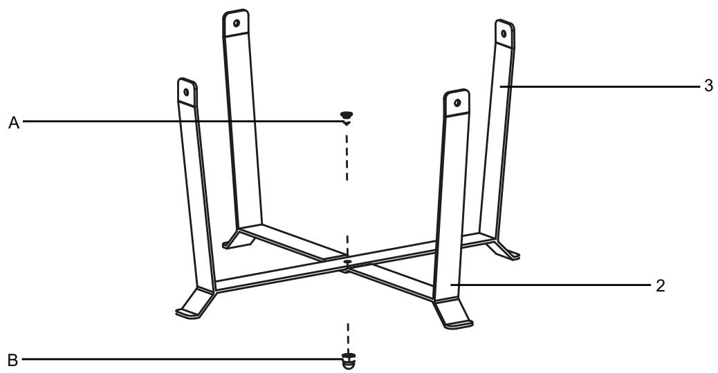
**ÉTAPE 2 :** Fixez le support assemblé à l'anneau de renforcement (1) à l'aide de quatre vis (A) et de quatre écrous bombés (B).
