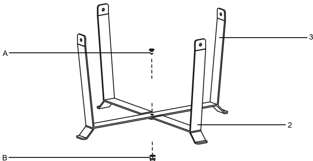
**STAP 2:** Bevestig de beugel uit STAP 1 aan de verstevigingsring (1) met vier schroeven (A) en vier halfronde moeren (B).
