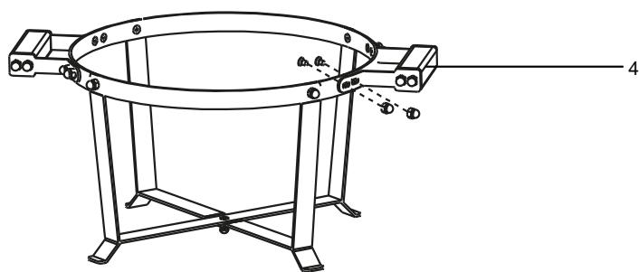
**SCHRITT 3:** Befestigen Sie die zwei Griffe (4) am Deckel des Verstärkungsrings (1). Richten Sie die Schraubenlöcher des Griffes an den vormontierten Schrauben am Deckel aus. Befestigen Sie den Griff (4) mit den vier vormontierten halbrunden Muttern (B).
