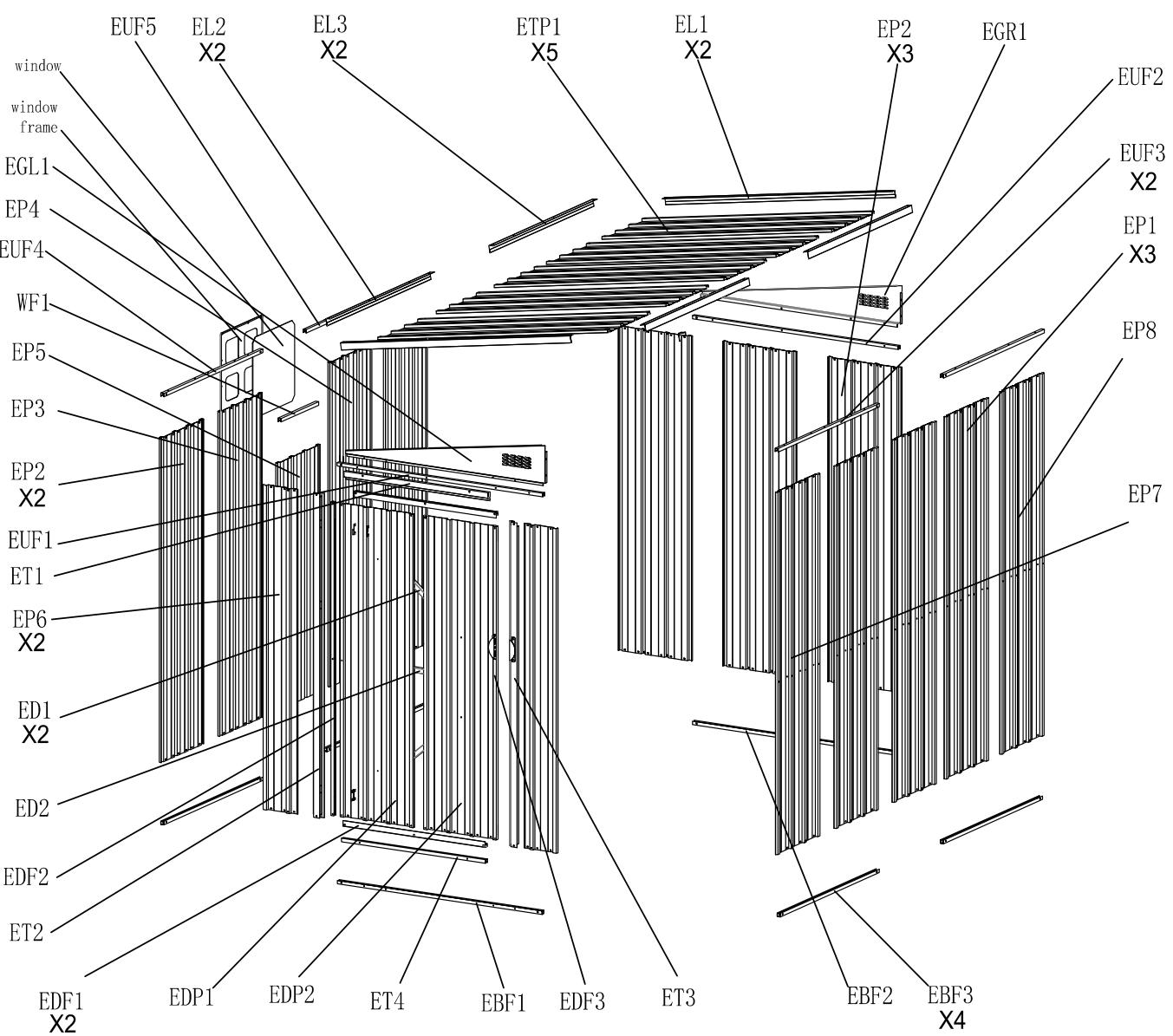
**PANEL ASSEMBLY/ASSEMBLAGE DE PANNEAUX/
