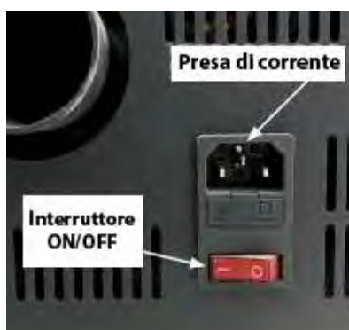
Connettore alimentazione + Interruttore ON/OFF
