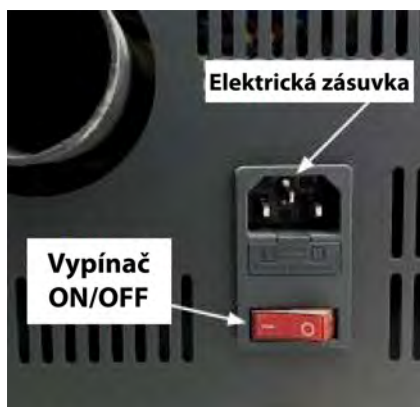
Konektor napájení + vypínač ON/OFF
