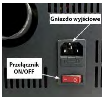
Złącze zasilania + przełącznik On/Off
