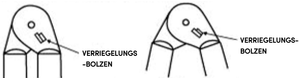
AUFBEWAHRUNGSPPOSITION MIT VERRIEGELTEM SCHARNIER (TRITTELEITER)
