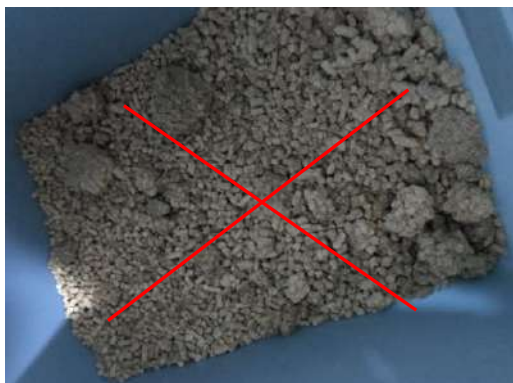
Agglomération de granulés de mauvaise qualité Attention : débrancher la prise avant le nettoyage.
