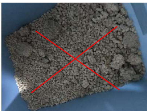
Agglomerazione di pellet di scarsa qualità
