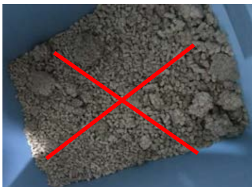
Agglomération de granulés de mauvaise qualité
