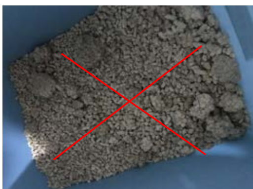
Agglomerazione di pellet di scarsa qualità
