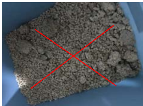
Aglomerção de pellets de baixa qualidade Cuidado: desligue a ficha antes da limpeza.
