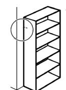
Voor een maximale stabiliteit raden wij u aan het rek te bevestigen aan de muur. Vijzen zijn niet meegeleverd in de verpakking.
